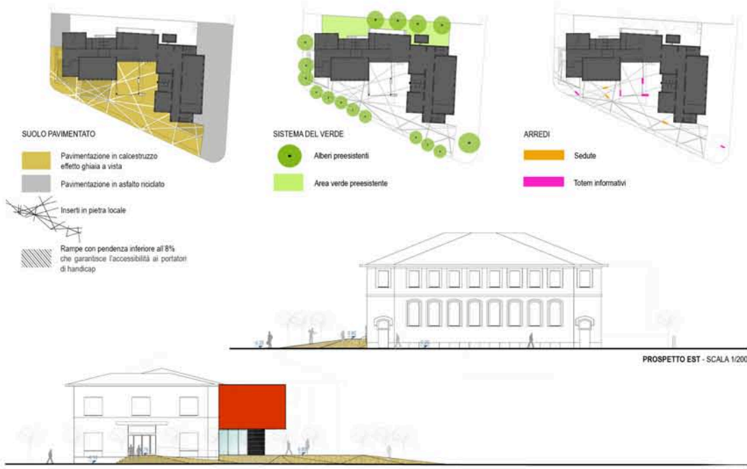
VISTA DELLO SPAZIO PUBBLICO E DELLO SPAZIO MOSTRE DA VIA CASTIGNOLI LATO VIA DEGLI ALPINI La realizzazione di rampe e fazzoletti inclinati integrati nel disegno della superficie pavimentata, permettono di superare l'attuale dislivello di circa 80 cm che separa il piano stradale dal piano terreno del Centro Civico. L'inserimento di punti di sosta e di totem informativi trasformano lo spazio esterno in luogo piacevole e sicuro, vera e propria piattaforma di ingresso al nuovo centro civico. L'involucro a "cappotto termico esterno" del piano primo dell'edificio C, è pensato in posizione aggettante rispetto ai limiti del piano terra e rispetto al filo delle finestre, proteggendo sul lato sud l'edificio dall'irraggiamento diretto. Lo spazio esterno pavimentato è stato immaginato in calcestruzzo effetto ghiaia a vista per ottenere una superficie continua monomaterica e monocromatica. Unico motivo grafico è costituito dall'inserimento di elementi 30x30cm in pietra locale ad evidenziare i cambi di pendenza della pavimentazione.
